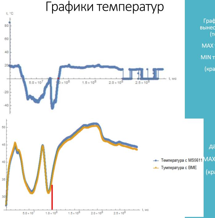
График с данных термодатчика, вынесенного за пределы аппарата (термодатчик атмосферы).
